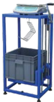
Устройство TW-1000 для гидростатического взвешивания вакуумных пикнометров
